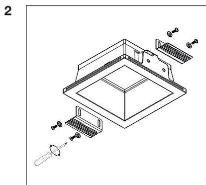
Отрегулируйте крепежный элемент (поз. 4) в зависимости от толщины потолка. Закрепите его с помощью винтов (поз. 5) и шайб (поз. 7), идущих в комплекте .
