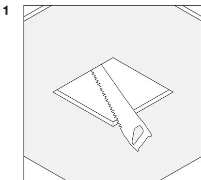
Сделайте отверстие в гипсокартонном потолке, соответствующее выбранной модели (размер АхВ) (см.паспорт светильника).
